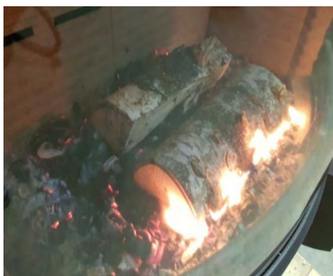
Figur 6 - Placering af brænde
