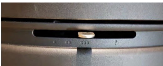
Figur 4 - Fuld sekundær luft
